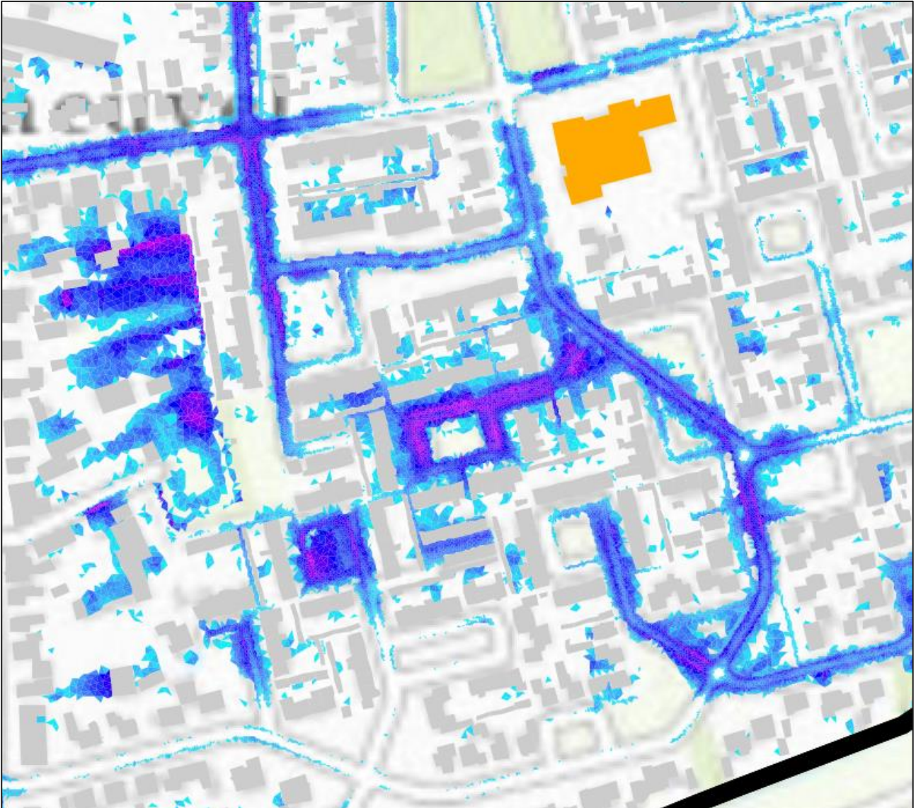
Figuur 3 Voorbeeld van een resultaat uit een hydraulische simulatie van water op straat bij 70 mm.
